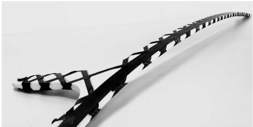
BILD 1 Prototyp des Dachrahmens, umgesetzt in AdditiveCarbon (© Cikoni)
