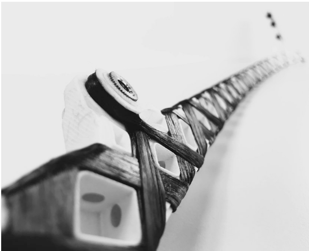
BILD 5 Detailsicht eines wickeltechnisch eingebundenen Lastenleitungs punkts (© Cikoni)
