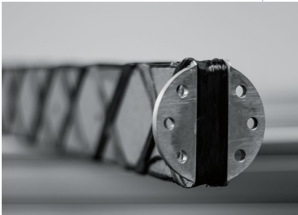
Bild 2 Robotergestützt eingewickelte metallische Lasteinleitungsstelle an einem Biegeträger für den Anlagenbau (© Cikoni)
